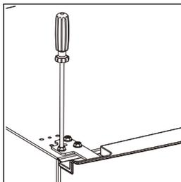
Conecte os chicotes da porta e do gabinete. Em seguida, recoloca a cobertura da dobradiça superior. Antes de fixar a cobertura, conecte os terminais do interruptor da porta.
