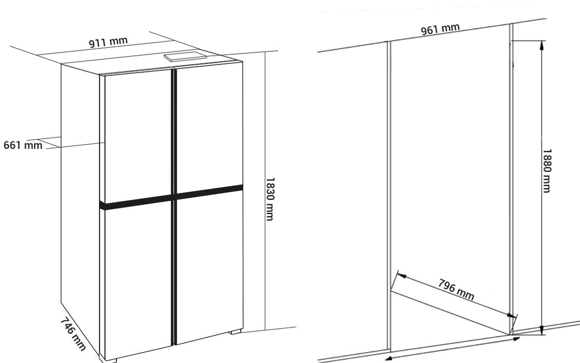
As figuras acima são um guia para propósitos de instalação, as dimensões do nicho podem variar ligeiramente. Mantenha espaço suficiente ao redor de seu refrigerador para que o mesmo funcione com a máxima eficiência.
