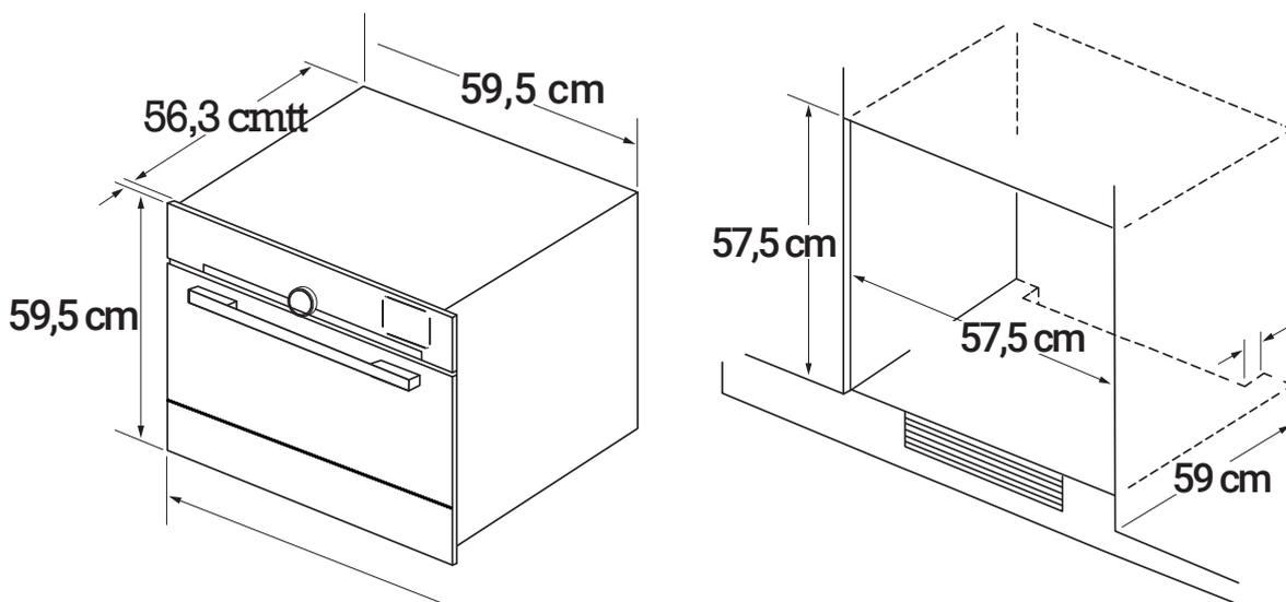
As figuras acima são um guia para propósitos de instalação, as dimensões do nicho podem variar ligeiramente. Mantenha espaço suficiente ao redor de seu micro-ondas combinado para que o mesmo funcione com a máxima eficiência.
