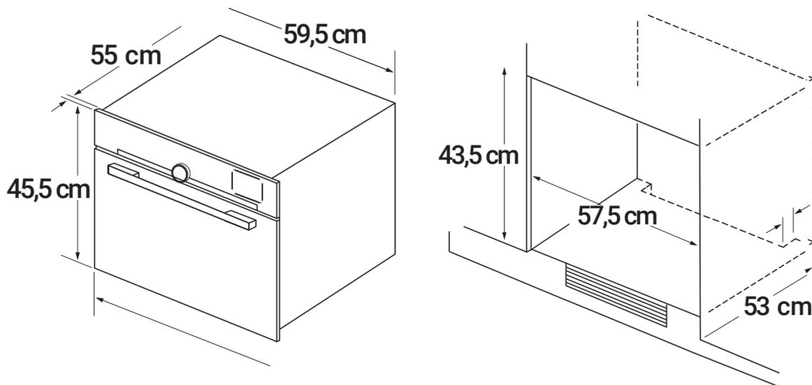
As figuras acima são um guia para propósitos de instalação, as dimensões do nicho podem variar ligeiramente. Mantenha espaço suficiente ao redor de seu forno combinado para que o mesmo funcione com a máxima eficiência.
