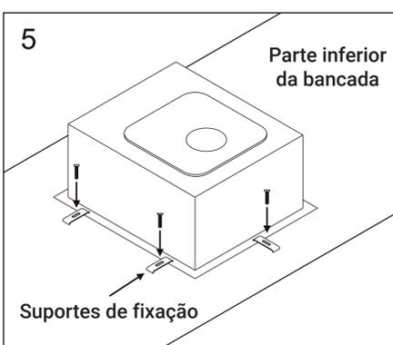
Posicione os suportes de fixação sobre a âncora de parafuso e aperte levemente na posição. Usando os parafusos fornecidos. Alinhe a pia no local desejado.
