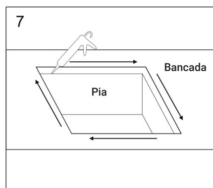
Aplique selante recomendado adequado para áreas úmidas para a pia de aço inoxidável e material da bancada.
