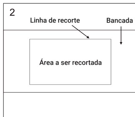
**Observação:** Antes de cortar, verifique novamente se as medidas de sua linha traçada estão corretas para as dimensões de sua bacia. Use a ferramenta de corte requerida apropriada para sua bancada, corte ao longo da linha.
