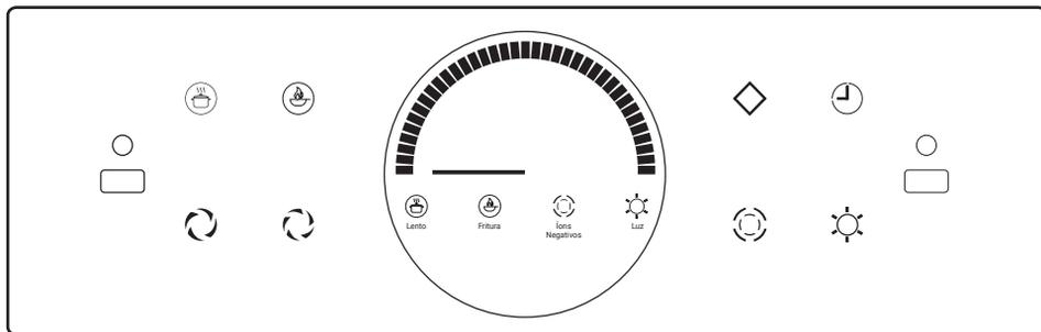
1 - Na tecla "◇": toque nesta tecla quando a tecla estiver desligada, a luz da tecla estiver acesa, a coifa estiver em modo de espera, a função da tecla de iluminação estiver ativada (e o ícone de iluminação for exibido sob o painel), e entrar no modo de espera, quando o botão é tocado novamente, o capô é desligado e a função de iluminação é desligada.
