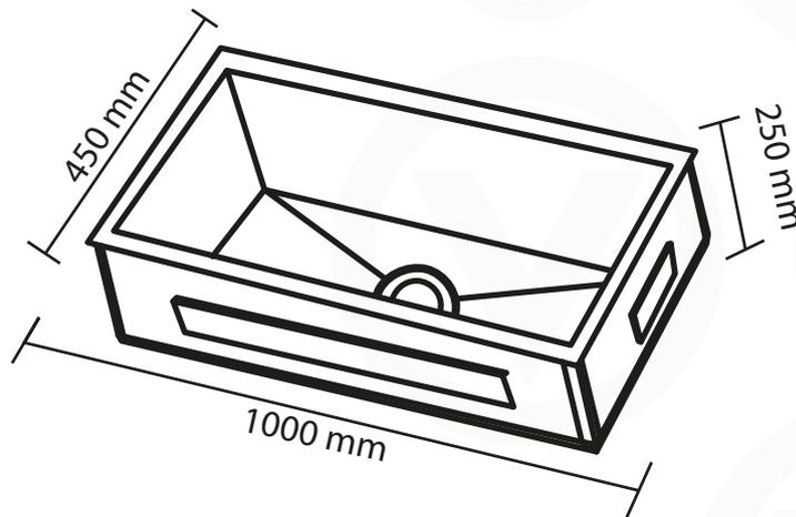
As figuras acima são um guia para propósitos de instalação, as dimensões do nicho podem variar ligeiramente. Mantenha espaço suficiente ao redor de sua coifa para que o mesmo funcione com a máxima eficiência.
