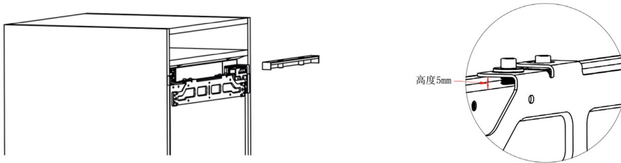
**2-** Utilize uma régua para medir a distância entre a parte superior do armário e o centro dos orifícios dos parafusos na linha inferior da placa de suspensão da porta e registre o valor a. Meça a distância entre a parte superior do gabinete e o centro da face lateral da porta da geladeira e registre o valor b. (Observação: a face lateral do corpo da porta refrigerada é o orifício do parafuso para fixar a placa de posicionamento de montagem)
