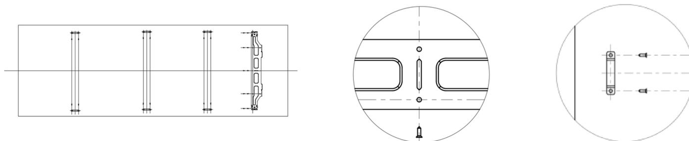
**6-** Coloque as placas de fixação laterais do corpo da porta nas placas de pressão das placas de fixação, em seguida, pendure as placas de madeira na porta fria. Depois que as placas de madeira forem penduradas, instale as porcas de ajuste na parte superior da porta. Em seguida, fixe a placa de fixação lateral do corpo da porta ao corpo da porta refrigerada e fixe-a firmemente.
